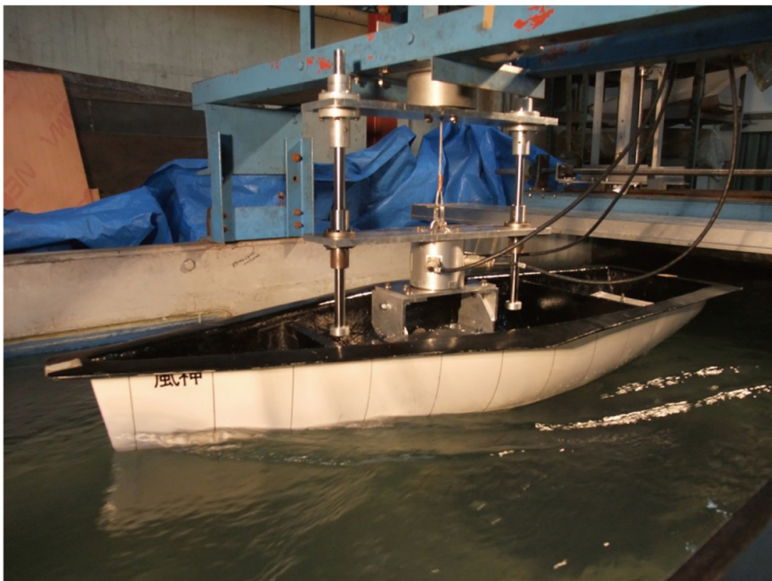
図 3.36 回流水槽における風神の水槽試験の様子
