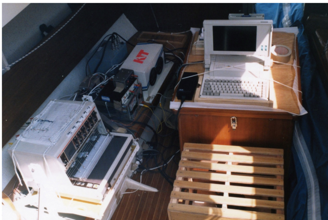
図 6.3 FAIR V の船内の計測機器の設置状況 (1991 年当時) (テーブル上にあるのはノートパソコンではなく、ラップトップコンピューター。手前の木枠の中にパーティカルジャイロを設置)
